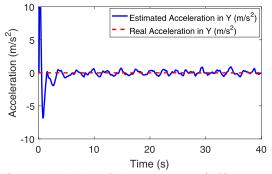
(d) Real and identified acceleration (ES) in y axis
